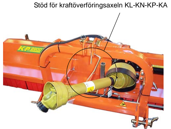
Stöd för kraftöverföringsaxeln KL-KP-KPU-KA
