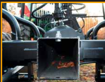
Bolten sørger for at den siste tømmerbanken ikke skal gli av – en billig og bra sikkerhetsdetalj på Palm-vogna.
