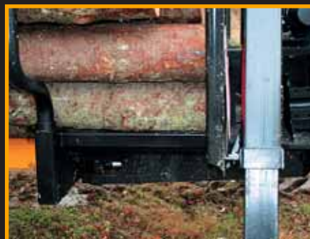
Källefäll har leddpunktet langt bak, noe som gir en mer følsom, men samtidig ustabil vogn.
