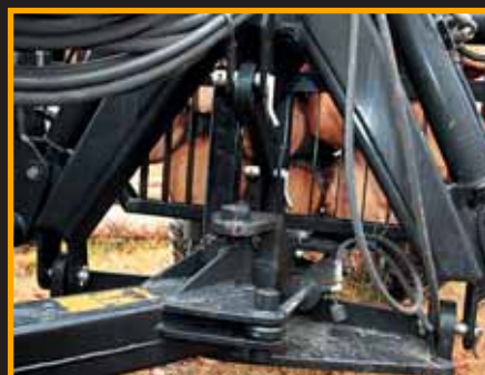
Nokka-krana kan lett flyttes fra vogn til traktor, vognstyringa har bare én sylinder.
